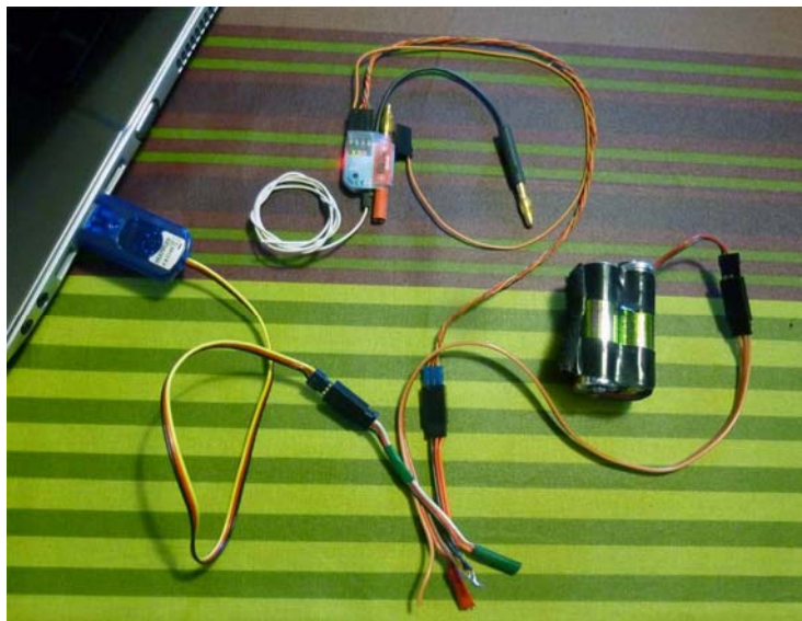
UniSens-E connecté au PC par l'adaptateur Multiplex USB, branché sur le connecteur LINK, via un câble en Y. L'accu 5 V est branché en parallèle sur ce même câble en Y [Unisens-PC_MPXUSB.jpg]
