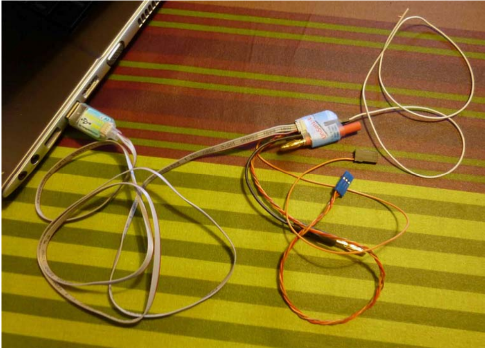
L'interface USB N° 2550, branché sur le port COM de l'UniSens-E relie directement le capteur au PC [Unisens-PC_2550.jpg]
