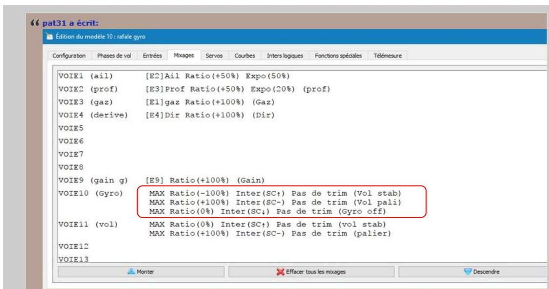
Dans la radio , tu vas dans le menu mixeur , tu sélectionnes la voie 10 , tu édites , tu laisses en "MAX" , tu affiches la valeur que tu veux en "ratio" , dans notre cas : -100 , 0 ou +100 , tu sélectionnes la position de l'inter dans la ligne "Interrupteur" que tu souhaites y affecter et tu met "Remplacer" dans la ligne "Operation" , tu sort de la page , tu recommence l'opération en sélectionnant "Insérer après" pour ta 2 eme position d'inter et de nouveau pour la 3 eme position .
