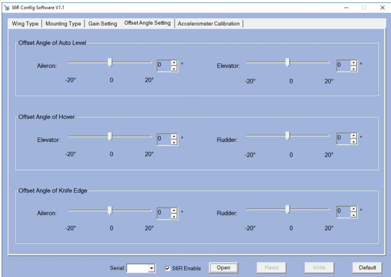
Il est également possible de configurer un angle de décalage. Cela peut servir si le récepteur n'est pas installé bien droit et aussi pour compenser un problème de géométrie du modèle.
