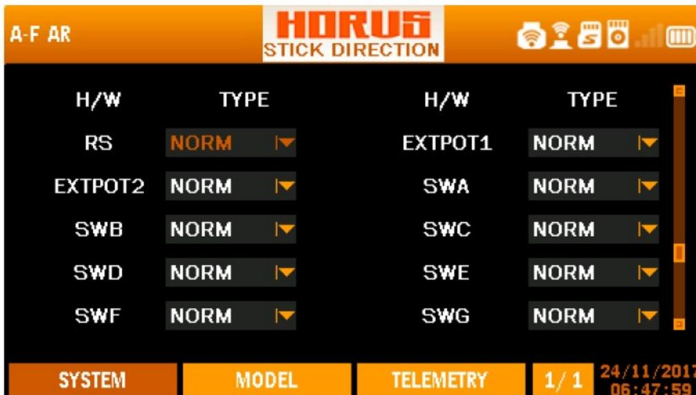
L'illustration ci-dessus est un exemple du menu "STICK DIRECTION", pour entrer dans ce menu appuyez sur la touche "SYS", puis sélectionnez "STICK DIRECTION". Ici, l'utilisateur peut inverser la direction du signal de tous les signaux matériels. Inverser la direction du canal de la transmission le signal allant au RX peut être fait avec l'option de "REVERSE", qui peut être trouvée dans le menu "MDL".
