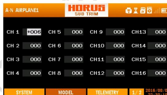
L'illustration ci-dessus est un exemple du menu "SUB TRIM", pour entrer dans ce menu, appuyez sur le bouton "MDL", puis sélectionnez "SUB TRIM". Ici, l'utilisateur peut changer la position neutre des servos / surfaces de contrôle qui dans les modèles sans tiges de contrôle réglables. le
